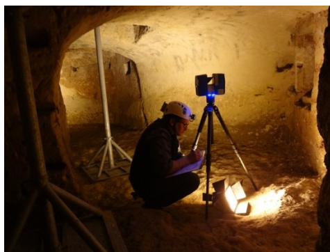
Fig. 3- Sotterranei. Fasi di rilievo eseguito nelle cavità rocciose ipogee con laser scanner 3D
