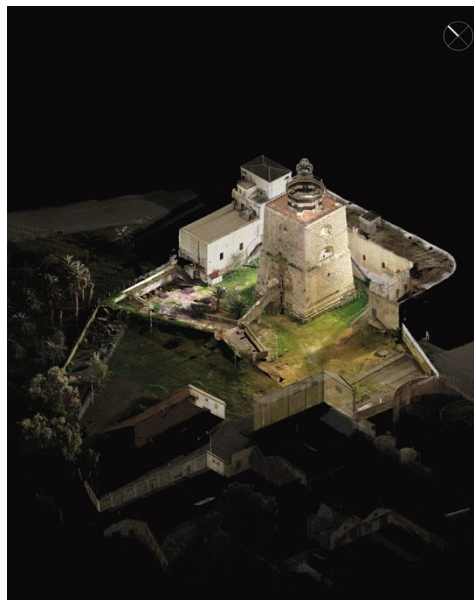
Fig. 3- Vista assonometrica della point cloud
