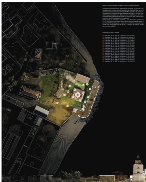
Fig. 2- Rilievo laser scanner e punti di stazione
