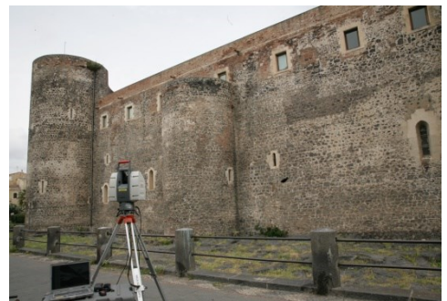
Fig. 6- La fase di scansione con il laser scanner 3D
