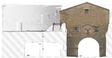
Fig. 12- Alzado y sección de la Puerta. Escáner 3D, fotogrametría y dibujo 2D
