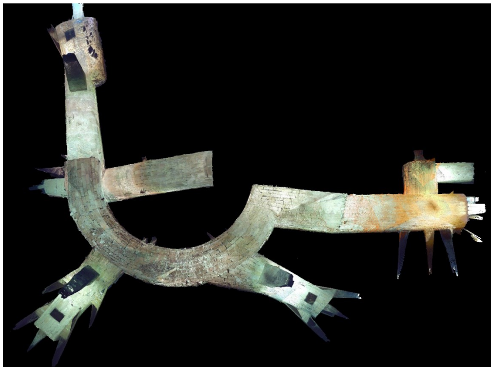
Fig. 11- Castello di Gallipoli. Torre della Vedetta, livello inferiore. Vista dall'alto del rilievo laser scanner 3D a colori delle postazioni di difesa e dei corridoi voltati (Mitello & Muscatello, 2018)
