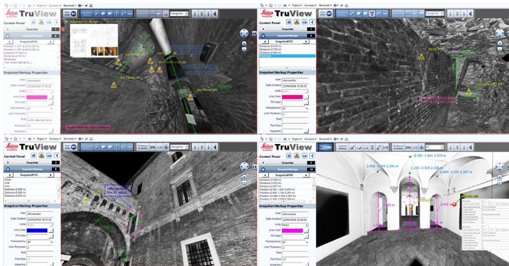
Fig. 12- Esplorazione delle nuvole 3D da TruView. la torre romana, l'intercapedine con i beccatelli, il cortile, la sala al livello 1: misure di distanze, coordinate di punti, link a documenti e altri scanworld
