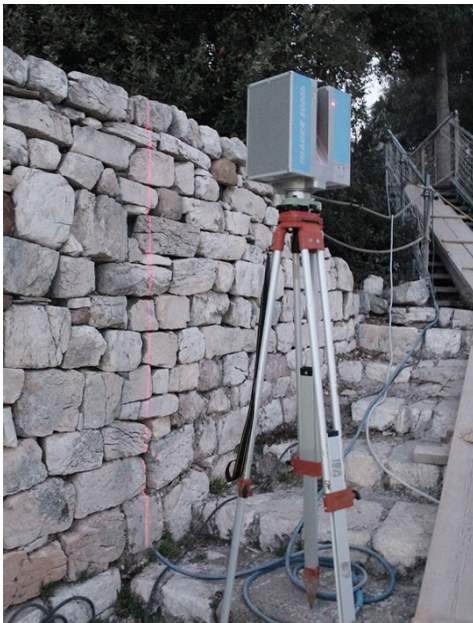
Fig. 4- Metodo di acquisizione per il rilievo laser-scanner
