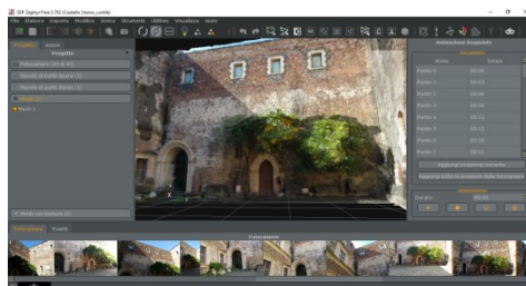
Fig. 9- Elaborazione 3D della corte interna – lato ovest, mediante software Zephyr (3DFlow)
