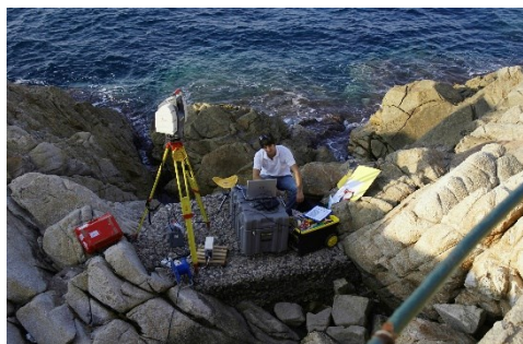
Fig. 2- Fasi del rilievo, con le ingombranti e poco maneggevoli strumentazioni utilizzate
