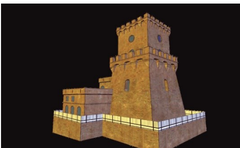
Fig. 5- Visualizzazione 3D della torre: sono individuabili gli ampliamenti, e le sopraelevazioni (elaborazione G. Di Crescenzo)
