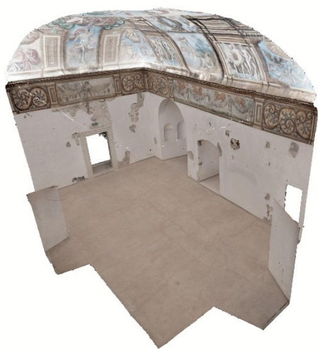
Fig. 4- Sala del Trono – mesh generata da nuvola di punti del laserscan (2016)
