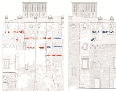
Fig. 9- Individuazione delle fasce apparecchiate a spina di pesce sui prospetti della torre, esterno (a sinistra) e visto dal cortile (a destra)
